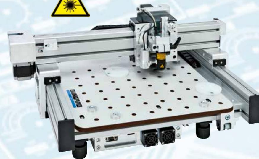
Mit dem Bungard CCD Laser Direct Imaging können Gebrauchsmuster schneller und genauer realisiert werden als mit der bisherigen Technik. Für Kleinserienfertigung empfehlen wir weiterhin das Herstellen eines Layoutfilms mit dem Bungard Filmstar und Belichtung mit Hellas oder - für feinere Auflösung mit der EXP 3040 LED.
