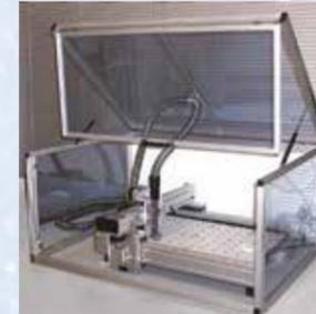
Auf Wunsch kann die CCD mit einem Vakuumschrank ausgestattet werden.
