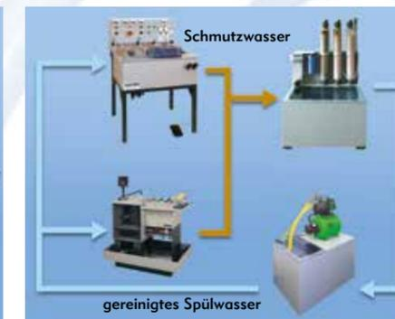
Selbstverständlich können die Maschinen der Ionex-Familie auf Ihre Bedürfnisse zugeschnitten werden. So reinigt zum Beispiel die Ionex XXL 1500 Liter Abwasser in der Stunde. Als Sondermodell filtert die Ionex AU Goldionen aus Spülwässern der Nickel-Gold-Oberflächenbeschichtung heraus. Diese können im Regenerationsprozess wiedergewonnen und dem Goldbad zugeführt werden.
