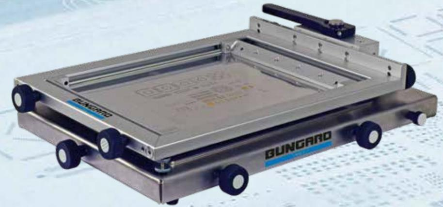
Für doppelseitiges Bedrucken fixiert man die Leiterplatte mit den Magnet-Leiterplattenhaltern (Notwendig bei der Verwendung des universalen Schablonenspannrahmens)
