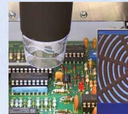
Die USB-Kamera ermöglicht eine optische Inspektion Ihrer Platine.
