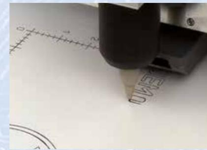
Ein Hauptaugenmerk bei der Entwicklung unserer CCD ist Multifunktionalität. Ein Plotstiftadapter ermöglicht, technische Zeichnungen anzufertigen.
