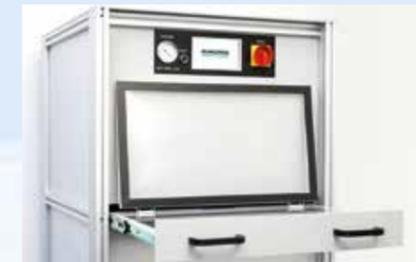
Contrairement aux lampes à vapeur de mercure classiques, le contrôle des émissions UV est quasiment superflu pour les installations à LED, car les LED ont une espérance de vie de plus de 10 000 heures avec une puissance d'émission très constante.
