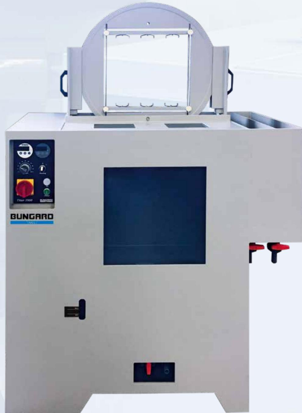
Pendant le processus de gravure, un motoréducteur et des rouleaux de transport font tourner en permanence la roue de tension.
