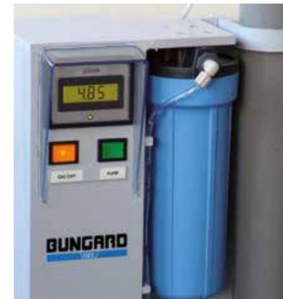
En option, l'Ionex peut être équipée d'un conductimètre (Ionex KA/KB) ou d'un appareil de mesure du pH (Ionex A/B). Vous pouvez ainsi contrôler en permanence la qualité de l'épuration des eaux usées.
