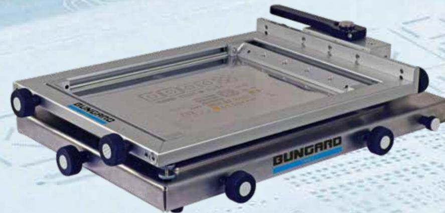
Pour l'impression double face, on fixe le circuit imprimé avec les supports magnétiques de circuit imprimé (nécessaire en cas d'utilisation du cadre universel de serrage de pochoir).
