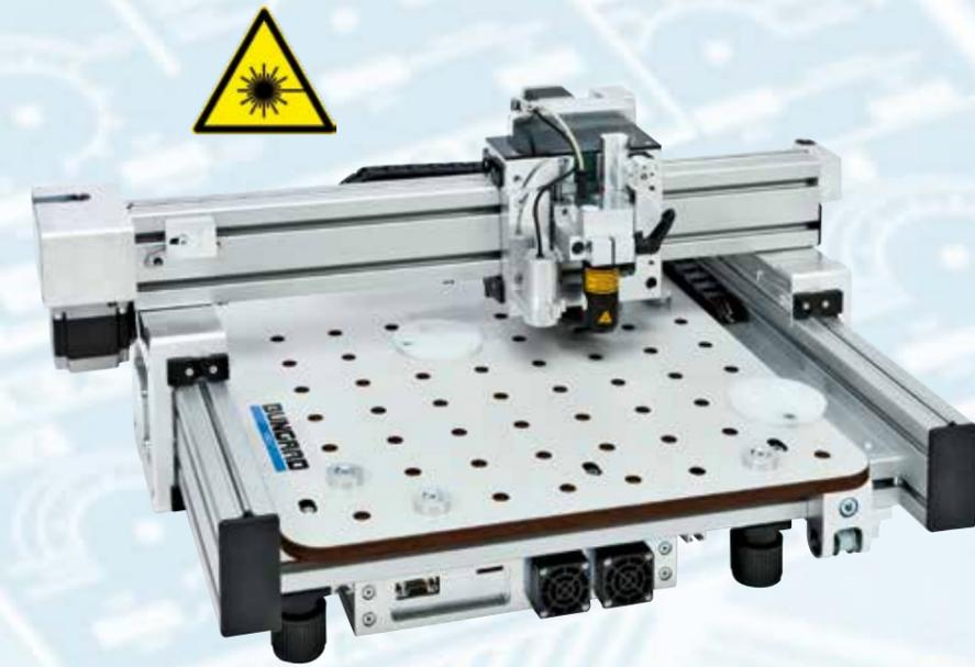
Avec le Bungard CCD Laser Direct Imaging, les modèles d'utilité peuvent être réalisés plus rapidement et plus précisément qu'avec la technique précédente. Pour la fabrication de petites séries, nous recommandons toujours la réalisation d'un film de mise en page avec le Bungard Filmstar et l'exposition avec Hellas ou - pour une résolution plus fine - avec l'EXP 8000.
