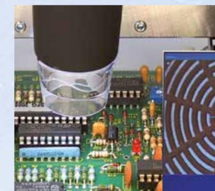
La caméra USB permet une inspection optique de votre circuit imprimé.
