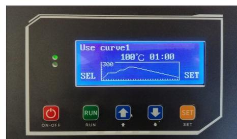
Mit **RUN** verlassen Sie den Einstellungsmodus und mit den Pfeiltasten wechseln Sie wie vorhin im Modus Löten (**WELD**) erklärt zwischen **READY**, **HEAT**, **WELD**, **HOLD** und **COOL** hin und her.
