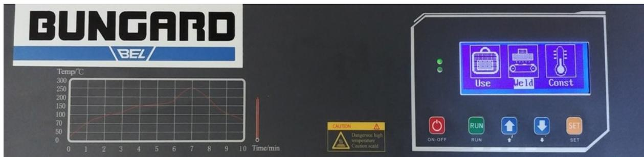
Auf dem Bedienfeld des Geräts befinden sich 5 Tasten: **POWER**, **UP**, **DOWN**, **SET** und **RUN**, wobei die Tasten **RUN** und **SET** Multifunktionstasten sind. Je nach Dialog befinden sich verschiedene Befehle über den Tasten, die durch Drücken der Tasten aktiv werden.
