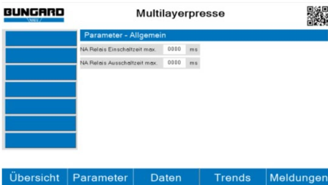
Das auf der Lastplatine angeordnete Not-Aus Relais verfügt über einen zweikanaligen Rückführkreis und überwacht sich somit in beiden Zuständen selbst. Die maximal zulässige Zeitdiskrepanz zwischen Ansteuerung und Rückmeldung kann hier definiert werden.
