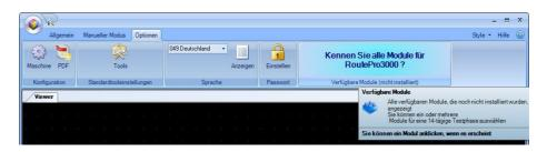
Alle Module können 14 Tage kostenlos und unverbindlich getestet werden. Öffnen Sie dazu Route-Pro3000 und gehen Sie auf TAB Optionen. Im rechten Bereich ist eine Animation, auf der die noch verfügbaren Module nacheinander angezeigt werden. Mit Klick auf das entsprechende Modul können sie die Testlizenz aktivieren. Bitte beachten Sie: für die Module LaserPro 3000, DispPro 3000, Calibrate 3000, Inspect 3000 und QR-Code 3000 ist separate Hardware erforderlich.
