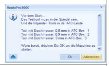
Bei einer manuellen Maschine werden Sie aufgefordert, das aktuelle Tool in die Spindel einzusetzen.
