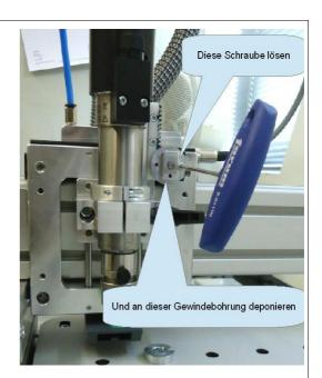
Der Frästiefenbegrenzer wird von unten auf die Spindel aufgesteckt und mit der schwarzen Schraube arretiert. Zum Wechsel des Tools, Frästiefenbegrenzer am besten kurz abnehmen. Das grüne Gleitstück ist ein Verschleißteil und kann bei Bedarf gewechselt werden.
