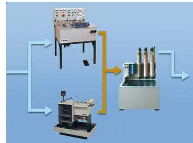
Abwasserfreier Spülkreislauf: In den Kreislauf geführten Versionen Ionex KA und KB werden neben den metallischen Kationen auch anionische Halogene herausgefiltert, so dass am Ende des Prozesses demineralisiertes Spülwasser zur Verfügung steht. Dieses Spülwasser wird mit einem Druckwassertank zurück zur Ätz- oder Durchkontaktieranlage gepumpt.
