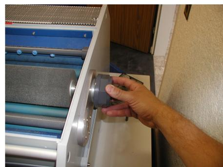
Blockieren Sie die Bürste per Hand und lösen Sie die Steckachse der Bürstwalze durch Drehen **im Uhrzeigersinn** (Linksgewinde) bis Sie sie herausziehen können. Nehmen Sie die Walze nun heraus und entfernen Sie die Spannhülse mit dem dafür mitgelieferten Spezialschlüssel.
