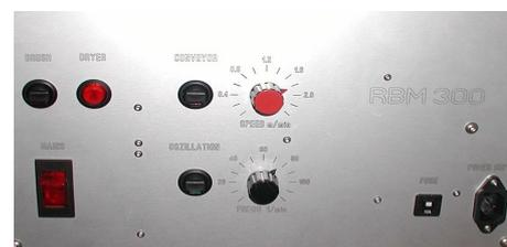
Schalten Sie die Oszillation ein (oscillation). Kontrollieren Sie, ob Sie die Oszillationsgeschwindigkeit mit dem Potentiometer variieren können.
